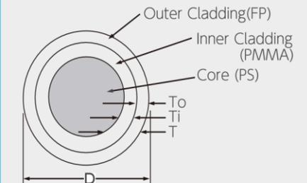
Cladding Thickness<sup>2)</sup>:  $T=2\%(T_o)+2\%(T_i)$
